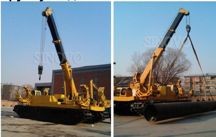
Кран-трубоукладчик TSDY38 имеет функцию подъема труб и является идеальным комплексным оборудованием для транспортировки стальных труб. Трубоукладчик оснащен вспомогательной лебедкой. Кроме того, машина может перемещаться в водно-болотных угодьях. Транспортировка трубоукладчика может осуществляться при помощи наземного транспорта.
