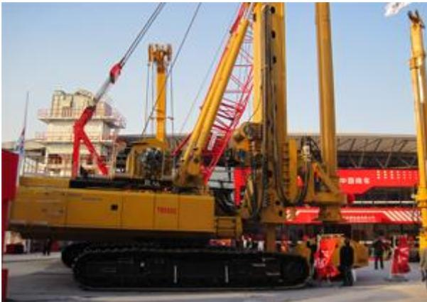
Роторные буровые установки серии TR разработаны в соответствии с новейшими передовыми технологиями, в составе преимуществ которых, то что в основе их устройства используется гусеничное шасси, которое является наиболее универсальным и используется в основном для глубокого бурения, в таких областях как строительство железной дороги, шоссе, мостов и небоскребов. Максимальная глубина укладки может достигать более 110 и более, диаметр может достигать 3,5 м.
