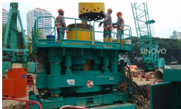
Роторная буровая установка является недавно разработанным нами оборудованием для бурения на обсадных колоннах, которое оснащается гидравлической системой питания и устройством передачи. Она управляется механической, электрической и гидравлической системами, что обеспечивает защиту окружающей среды и высокую эффективность.
