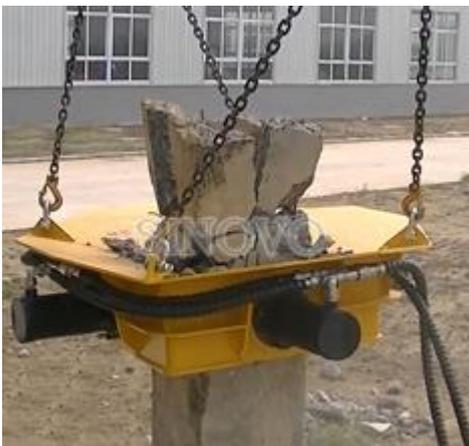
Благодаря применению 5 запатентованных технологий, наше гидравлическое оборудование является идеальной и эффективной машиной для срубki оголовков свай.
