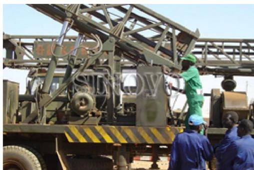
Устройство бурения водных скважин является установкой для бурения скважин для добычи воды, установки подземных труб и очистки колодцев. В основном состоит из блока питания, долота, штанги, основного ствола, бурильной трубы и т. п. Существуют три типа буровых установок для бурения водяных скважин, это роторные дрели, ударные дрели и сочетания нескольких видов сверл.
