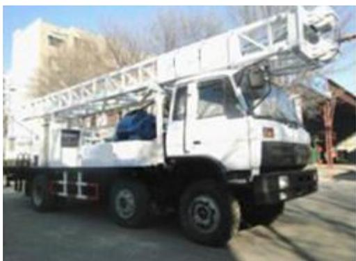
Устройство бурения водных скважин является установкой для бурения скважин для добычи воды, установки подземных труб и очистки колодцев. В основном состоит из блока питания, долота, штанги, основного ствола, бурильной трубы и т. п. Существуют три типа буровых установок для бурения водяных скважин, это роторные дрели, ударные дрели и сочетания нескольких видов сверл.
